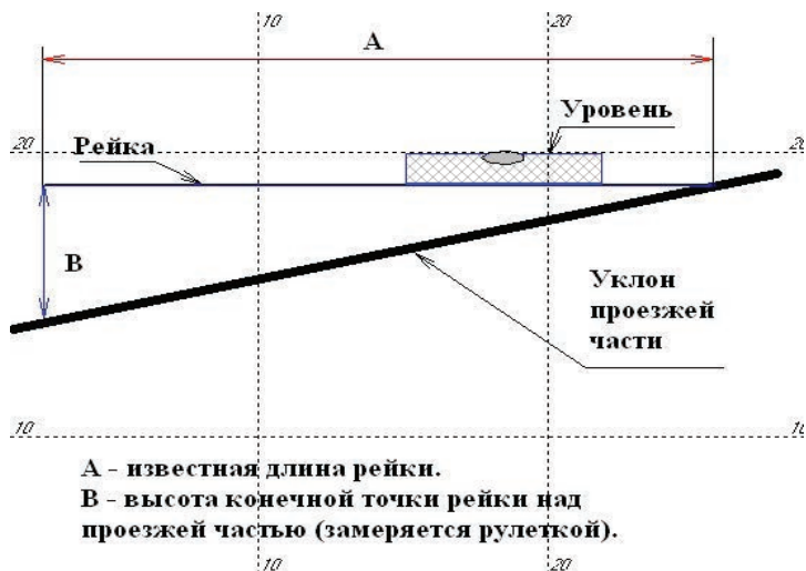
Рис. 2. Изображение способа определения уклона проезжей части
